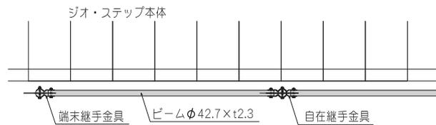
※鋼管により基礎を形成し手摺りを直接地盤面に設置する鋼管基礎設置タイプです。
